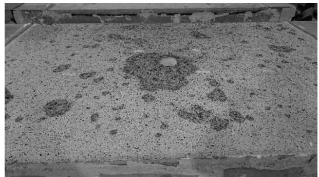
図-8 耐火試験後の供試体
