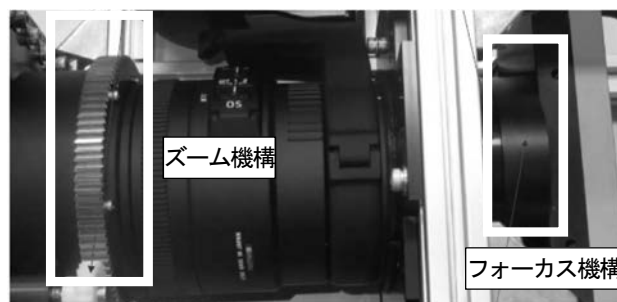
図-8 ズーム、フォーカス制御機構
