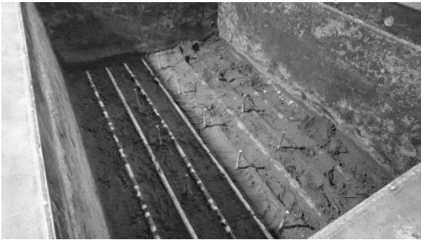
図-17 防護管の変位計測時における土槽の様子
