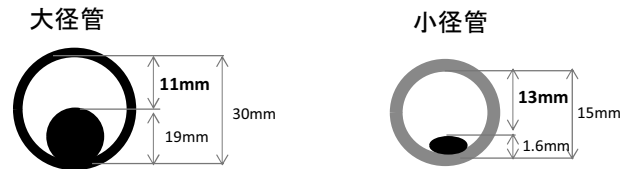
図-20 防護管とケーブルの寸法
