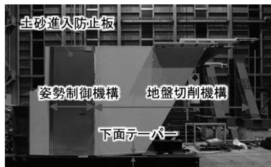
図-2 試作した刃口および姿勢制御機構 (側面)
