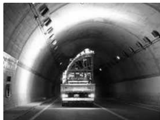
図-1 走行型トンネル撮影状況
