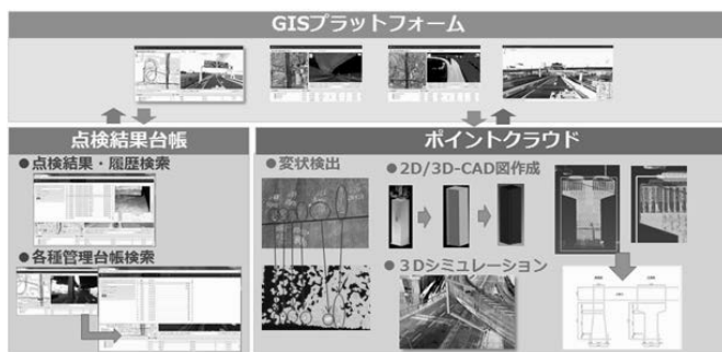
図-2 InfraDoctor システム概要 1)
