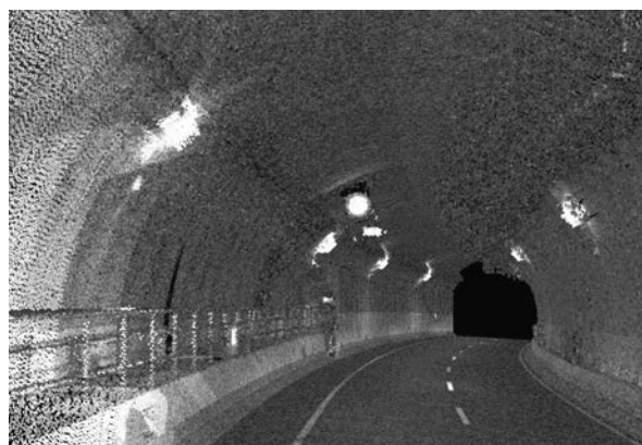
図-5 トンネルの点群実測例 (内部空間)
