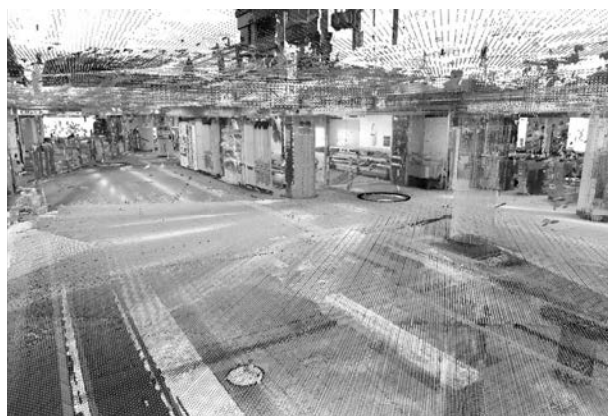
図-2 駅コンコース階の点群データ画像
