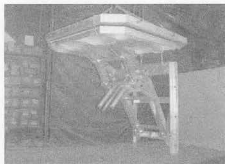
写真-13 浸水深さ6m以上対応可能な浸水防止器
