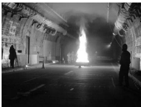
写真-2 火皿による模擬火災の状況
