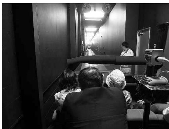
写真-2 夜間視認性能試験室 (全長100m、夜間時の全天候を再現することができる)
