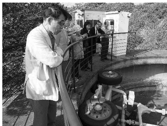
写真-1 タイヤ走踏試験機 (道路の標示や道路鋸の耐久性を測定する装置)
