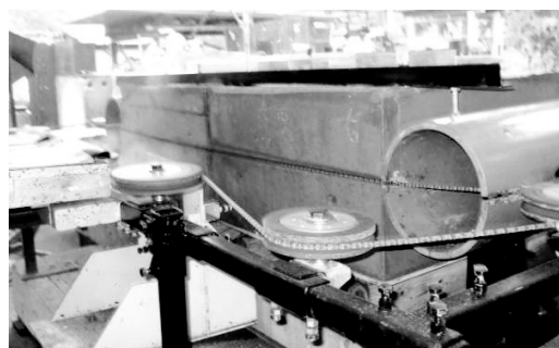
写真-1 切削ワイヤー性能確認試験実施状況
