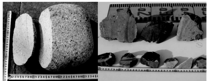
写真-5 支障物切断（左：玉石，右：砕石，ガラ）
