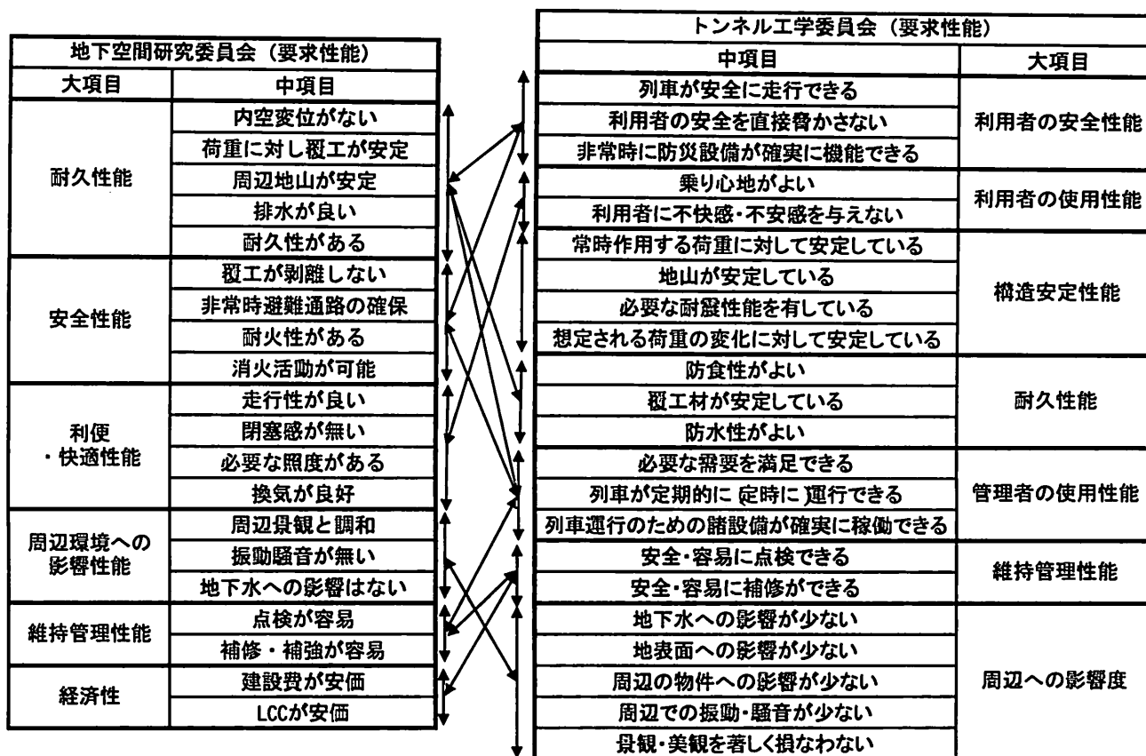
図-1 地下空間研究委員会 1) とトンネル工学研究委員会 2) の要求性能の対比
