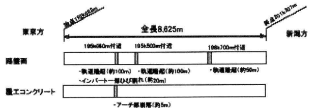
図-2 魚沼トンネル全体被害状況
