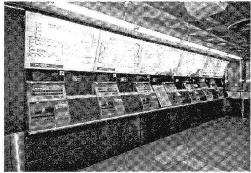
写真-2 大型かつ内照式に変更した運賃表
