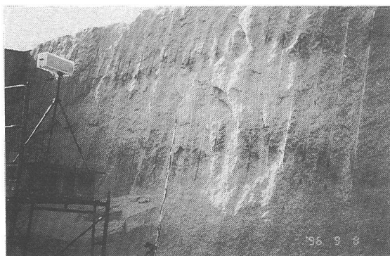
図-2.16 稲田採石場 ABC 壁面の 90° 入射による反射音特性
