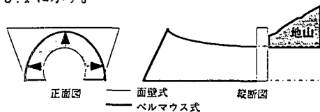
図-3.1 ベルマウス式と面壁式の差異
