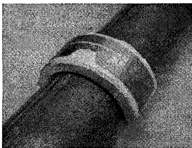
図-3 ICタグの設置方法
