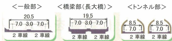
(a) 道路構造及び標準断面 10) (単位:m)
