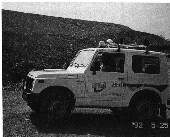
写真-2 GPS走行連続測量
