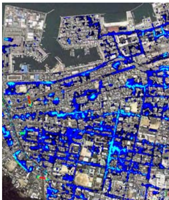
図-7 時間雨量100mmにおけるシミュレーション結果(約30分後)
