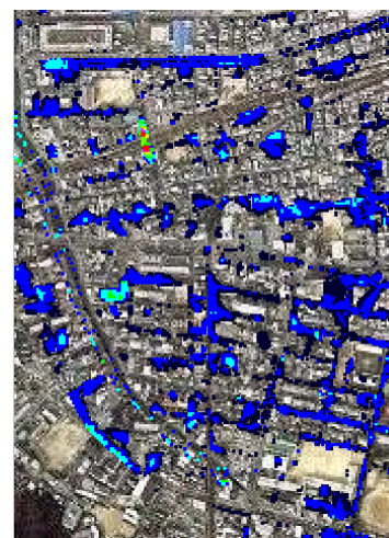
図-10 排水ポンプ設置あり
