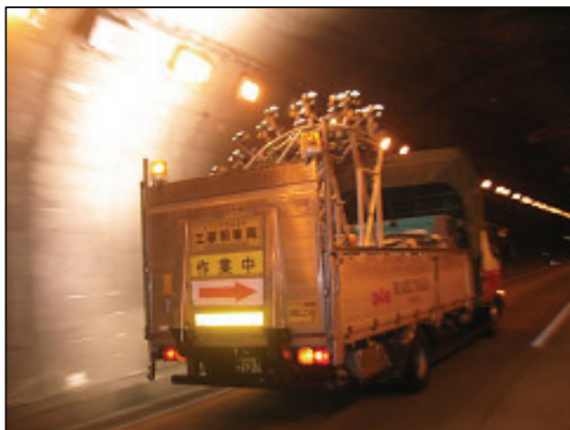
図-1 ひび割れ検出システム 3)
