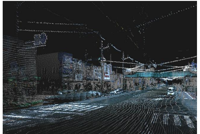
図-3 道路空間の点群データ
