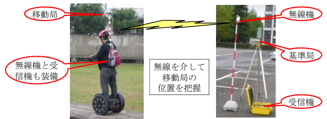
図-13 移動体でのGPS受信実験
