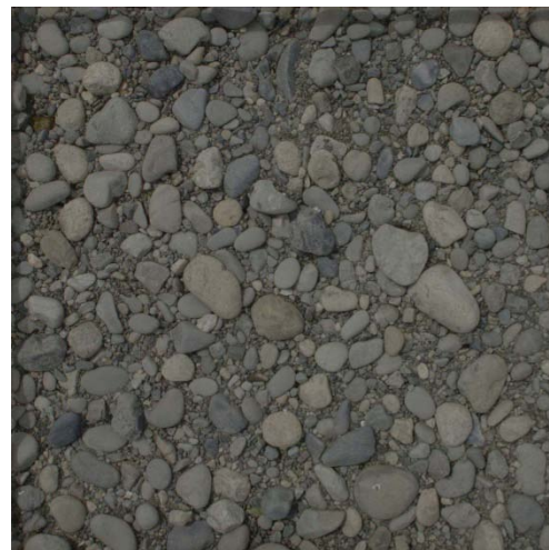
図-3(b) レンズ歪み除去後にコドラート領域を射影変換した画像
