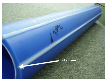
写真-1 PE 管光ファイバセンサの概観 3)
