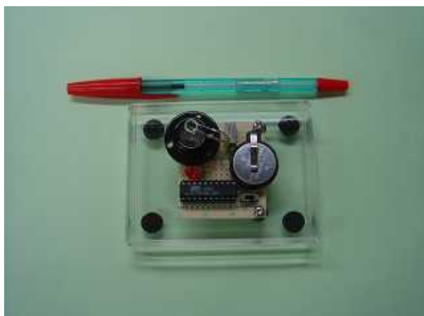
図 - 3 : 開発した垂直判定センサ
