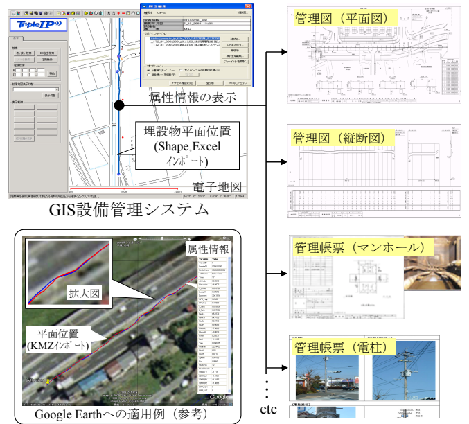
図-26 GIS を利用した通信設備管理例
