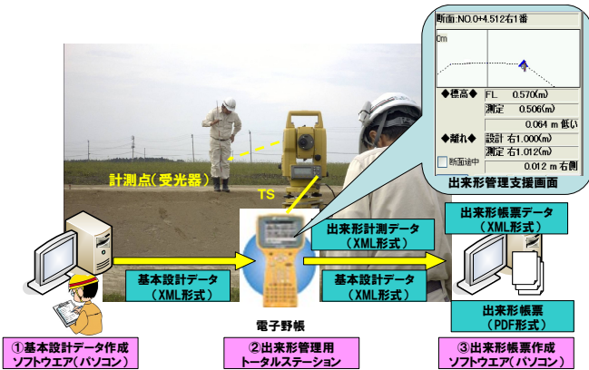
図-4 出来形管理用TS
