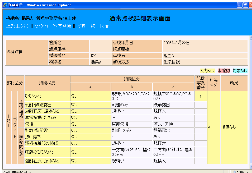
図-8 通常点検 DB' 07 通常点検詳細表示画面
