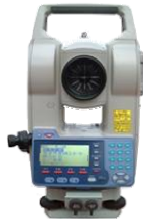
図 - 5 クラックスケール内蔵光波測量器
