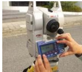
図 - 6 新システムによるひび割れ計測
