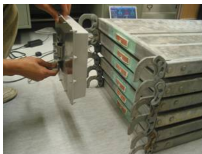
(a) タグに対してアンテナ垂直 (b) タグに対してアンテナ水平(横) (c) タグに対してアンテナ水平
