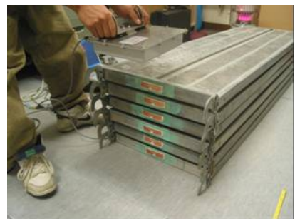
(a) タグに対してアンテナ垂直 (b) タグに対してアンテナ水平(横) (c) タグに対してアンテナ水平
