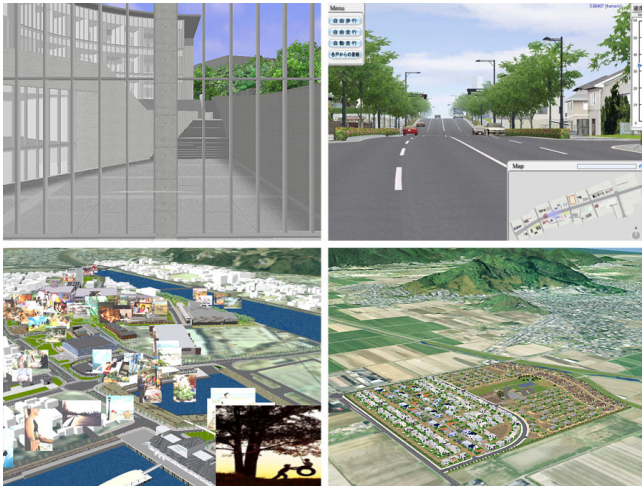
図-1 3DVR システムの例。左上：建築設計、右上：道路設計、左下：周辺環境・活動・場の統合デザイン 8) 、右下：地域計画
