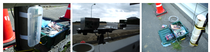
磁気センサユニット (250W × 90H × 30Dmm)
