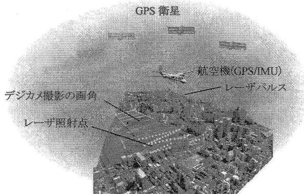
図-1 航空レーザ計測イメージ 1)
