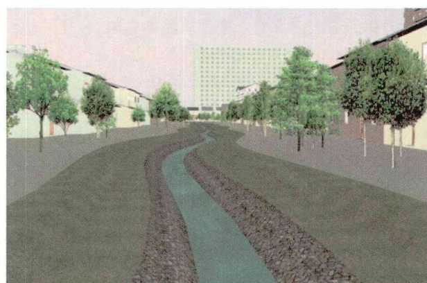
図—3 設定された断面図と生成された3次元水路モデル
