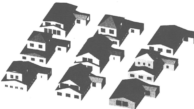
図-12 同一の6点ポリゴンの敷地に対して異なるパラメタセットを使って自動生成した建物群
