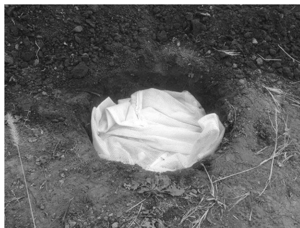
図-3 碎石を詰めた後の試験孔．
