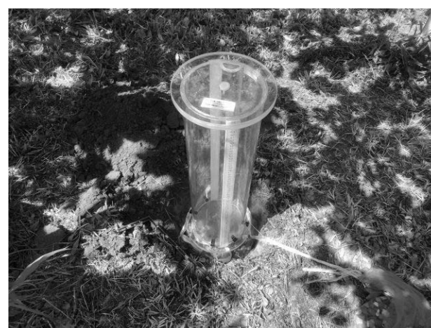
図-4 試験孔に設置した透水係数計測装置．
