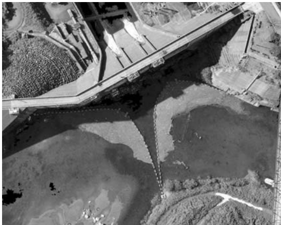
図-20 3次元点群データにて表現された月光川ダムに浮遊する捕捉流木群の様子
