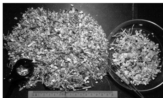
写真2 マイクロプラスチックの抽出
