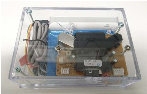
図2 PPD 60PV センサーを組み込んだ個人曝露測定装置
