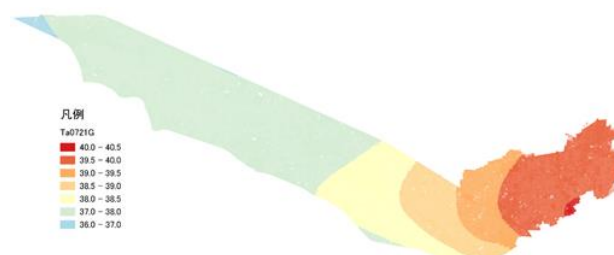
図-2 クリギング法による気温分布
