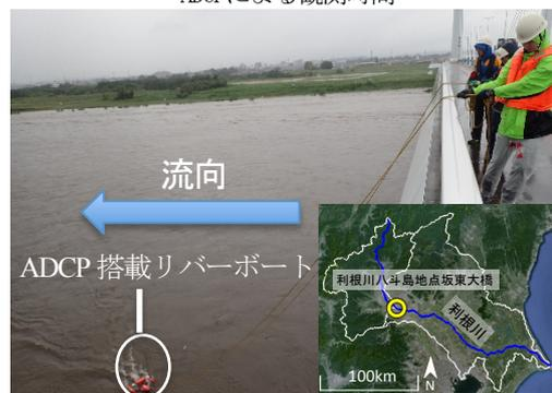
図-2 ADCPによる流量観測の様子
