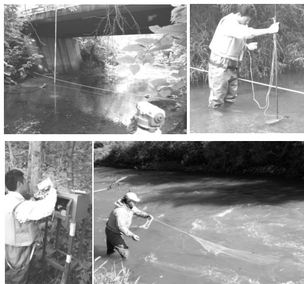
図4 河川流量推計のための横断面測量（上段・左）、流速測定（上段・右）、流量データ回収（下段・左）および魚類生息調査（下段・右）風景
