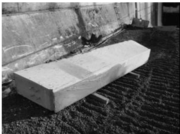
図-7 引抜き後の既設コンクリート
