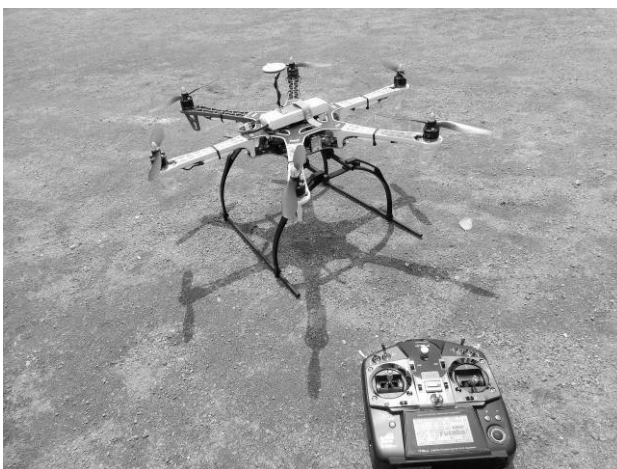
写真-9 6ロータ UAV 例(DJI F550)
