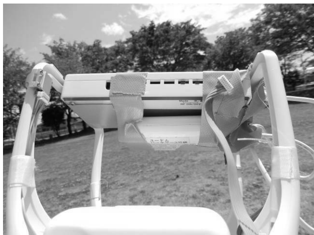
写真4 UAV スキッドに取り付けたCO2 デテクターC2D-W02TR
