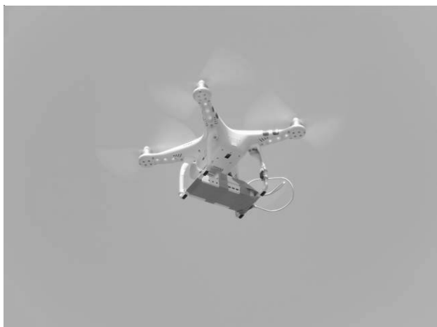
写真5 CO2 デテクターC2D-W02TR を取り付けて上昇中の UAV
