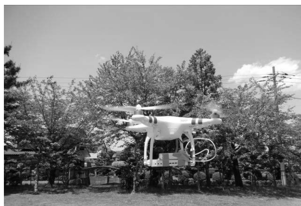
写真6 CO2 デテクターC2D-W02TR を取り付けて静止する UAV
