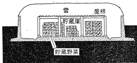
図3：1988年建設の半地下式の雪室
