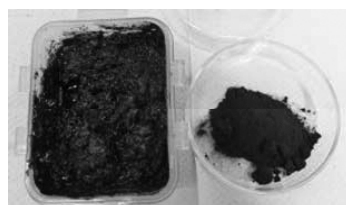
Figure 3 油処理前(左)と処理後(右)の油性廃棄物(例: UBD)
