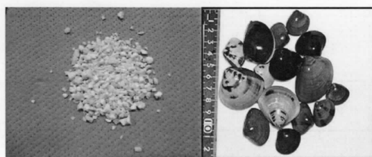
図-3 貝殻を破碎処理した底質改善材（粒径1～3mm）
