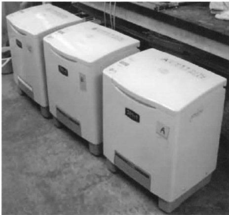
写真2 土壤改良資材試作の際に使用した生ゴミ処理機
