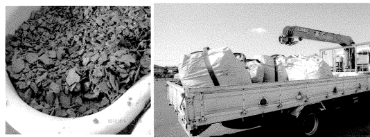
写真-2, 3 生態系保存型浚渫工法によって回収された城沼浚渫脱水土
